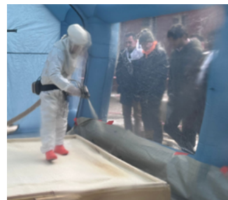
Démonstration de projection de mousse de polyuréthane
